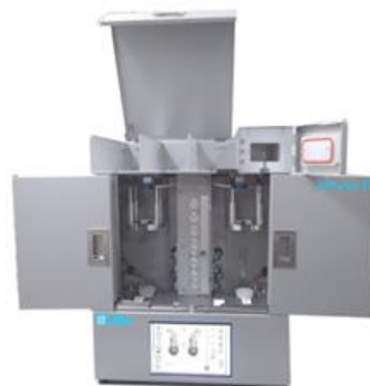
幹細胞高密度大量培養装置「Achieva-CS」
