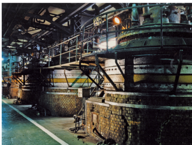
生産開始以来、1998 (平成10) 年の生産停止まで使われたインジゴ濃縮釜
