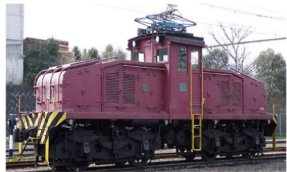
現在も原料・製品の輸送で使用している 旧三池炭鉱専用鉄道の電気機関車
