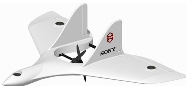
(Wing span 2,169mm× length 1,579mm× height 594mm)
